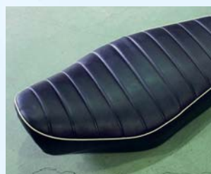
④ 完成。今回はマイナスドライバー、ラジオペンチ、白色マジック、はさみ、エアータッカーを使用しました。
