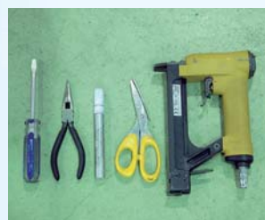
④ 完成。今回はマイナスドライバー、ラジオペンチ、白色マジック、はさみ、エアータッカーを使用しました。
