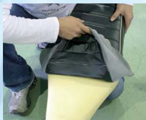
① シート表皮のステーブル(針)を取り、シート表皮をはがします。
