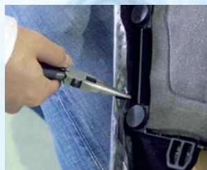
① シート表皮のステーブル(針)を取り、シート表皮をはがします。
