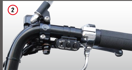
2 クラシカルなイメージを強調するスイッチキット。 カプラーオン仕様で簡単取付。
