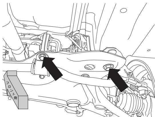
4. ブラケットA、ブラケットBを車体に取り付けます。この時点では仮組みとして下さい。
