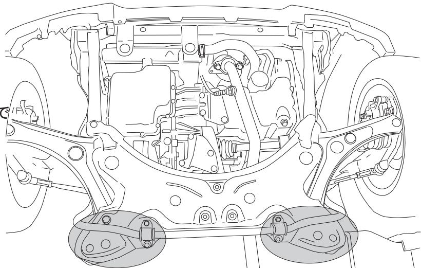
2. 横図の場所に取り付けますので取り付け位置を確認してください。
