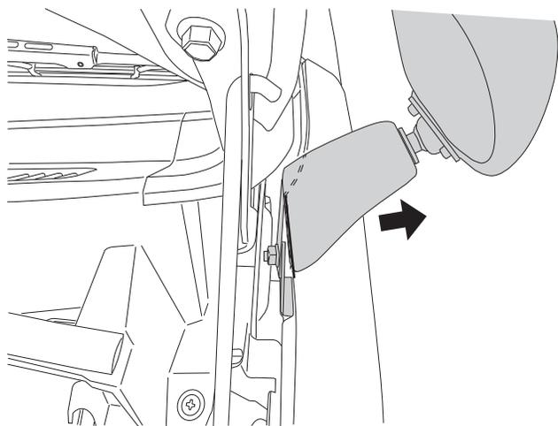
6. スタイリッシュアンダーミラーがコーナーパネルのラインに出来るだけ近づくように調整して、テープを車体に密着させます。
