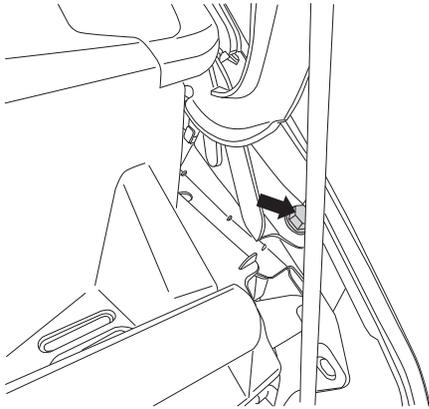
2. ボンネットを開け、フロントコーナーパネル左側のボンネットヒンジボルトをステーが差込める程度（車体とボルトの座面で約2mm）緩めます。
