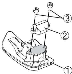
5. アクセルペダルNEO①にストッパー②をボルト③で取り付けます。
