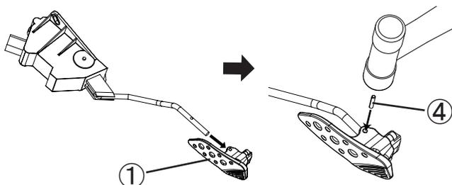
6. アクセルレータロッドにストッパー②を取り付けたアクセルペダルNEO①を差込み、スプリングピン④で固定します。
