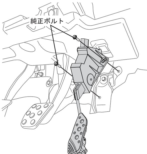
7. アクセルレータアセンブリを取り外しと逆の手順で取り付けます。
