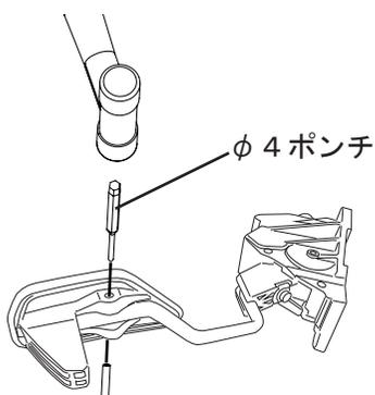
4. φ4のポンチを使用して純正アクセルペダルを固定しているスプリングピンを打ち抜き、アクセルレータペダルアセンブリから取り外します。
