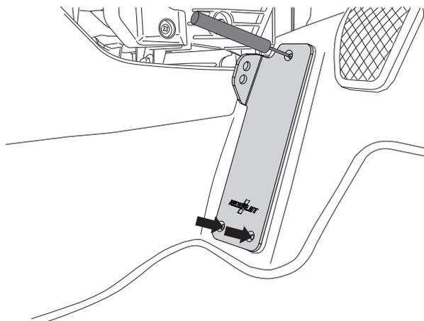
1. ブラケット①をフットレスト部に合わせ、3箇所の穴部にマーキングし、キリまたは千枚通しなどの穴あけ工具を使用して、深さ30mm程度の穴を開けます。
