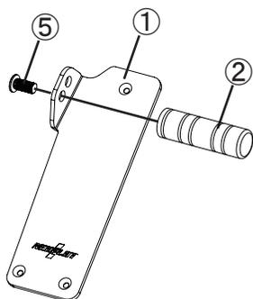
6. ボルト⑤を使用してブラケット①にフットバー②を取り付けます。
