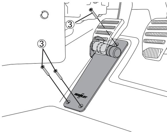
7. フットバー②を取り付けたブラケット①をサラタッピングビス③を使用して車体に取り付けます。
