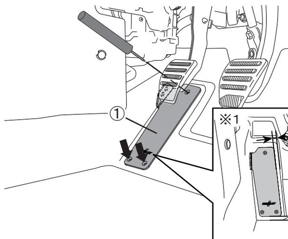
3. ブラケット①をフットレスト部に合わせ、3箇所穴部にマーキングし、キリまたは千枚通しなどの穴あけ工具を使用して、深さ30mm程度の穴を開けます。
