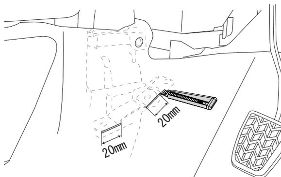
4. ブラケット①にフットバー②をボルト③を使用して固定します。
