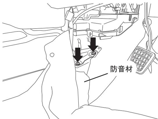
3. フロアカーペットをセンターコンソール側に押さえ、車体ステーの位置を確認し、ステーの位置に合わせてフロアカーペットを2箇所、20mmずつカッターナイフなどで切れ込みを入れます。
