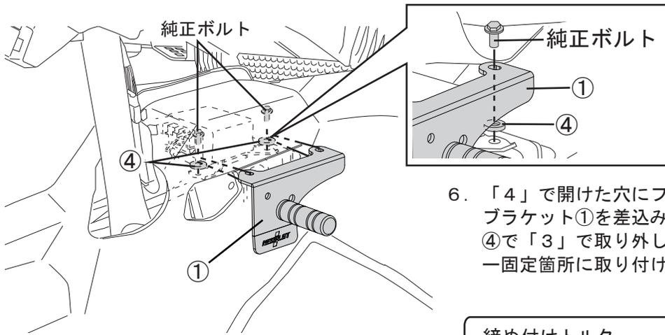
6. 「4」で開けた穴にフットバー②を取り付けたブラケット①を差込み、純正ボルト、ワッシャー④で「3」で取り外したエアバックコントローラ一固定箇所に取り付けます。
