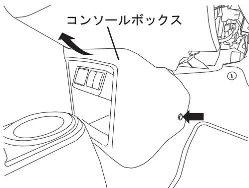
1. コンソールボックス運転席側のブラッシュクリップを取り外し、コンソールボックスを手前に引き、取り外します。
