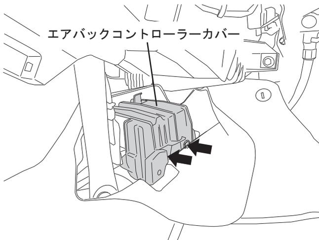
2. フロアカーペットをめくり、エアバックコントローラーカバーのプッシュプルクリップを片側2箇所ずつ、合計4箇所取り外し、エアバックコントローラーカバーを取り外します。
