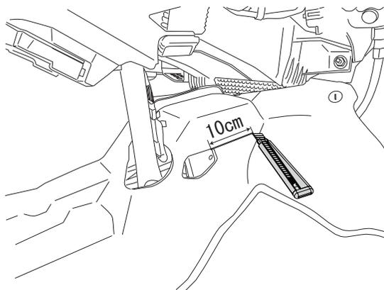
4. フロアカーペットを元に戻し、カットされている部分の上面と平行にカッターナイフなどを使用して、フロアカーペットを10cm切れ込みを入れます。
