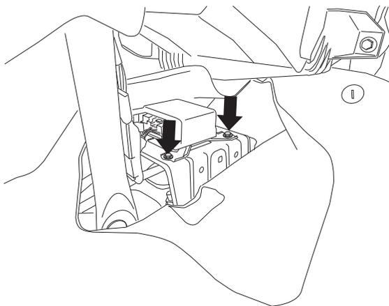
3. エアバックコントローラーの右側の純正ボルトを取り外します。
