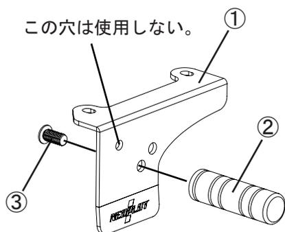
5. ブラケット①にフットバー②をボルト③を使用して固定します。
