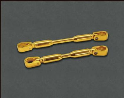
伸縮自在のアジャスタブルハンドルブレース。クランプ部の穴の中心から中心までで260~320mmまで調節可能。ミニ系ハンドルまで網羅出来るType-Sは200~260mmまで調整可能。ハンドル径φ22.2に適合。アルミ製。
