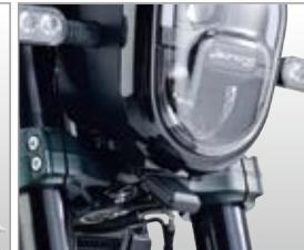
Dタイプ装着例 ベネリ LEONCINO 250 アンダーブラケット下に固定
