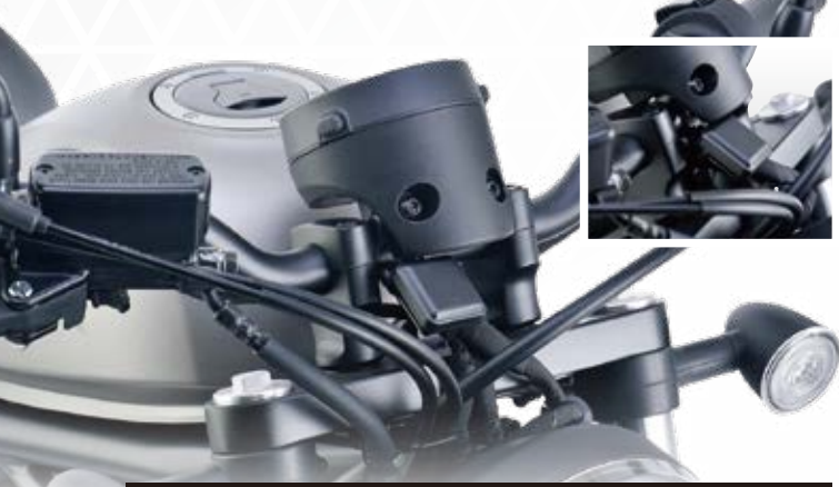
Dタイプ装着例 ベネリ LEONCINO 250 アンダーブラケット下に固定
