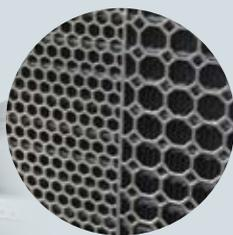
前輪の飛石が当たり易い中央部は目を細かくすることで保護性能を向上。横部分は目を大きくすることで冷却効果を優先させています。チタンならではの素材感で定番カスタムをさらに一歩上の舞台に引き上げます。
