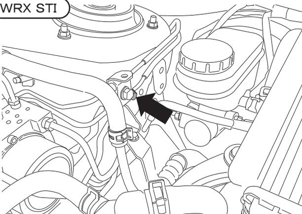
1. ボンネットを開け、矢印部分のボルトを取り外します。
