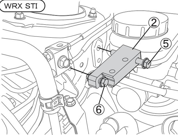
2. 左図のようにマスターシリンダーストッパーベース②にボルト⑤⑥をあらかじめ通し、取り外したボルト部分、サービスホールにマスターシリンダーストッパーベース②を各ボルトを使用して取り付けます。
