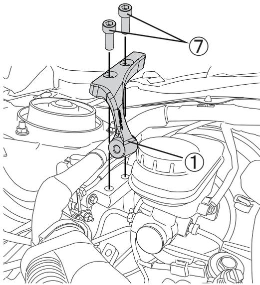
3. マスターシリンダーストッパーベース②にマスターシリンダーストッパー①をボルト⑦を使用して組み付けます。
