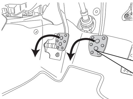
1. ブレーキペダルパッド（クラッチペダルパッド）を取り外します。
