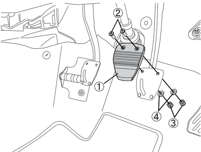
5. ブレーキペダル（クラッチペダル）にブレーキペダルNEO①をボルト②、ワッシャー④、ナット③で取り付けます。
