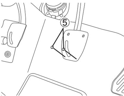
4. ブレーキペダル（クラッチペダル）に両面テープ⑤を貼り付けます。
