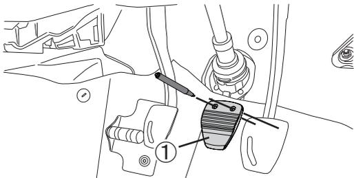
2. ブレーキペダル（クラッチペダル）にブレーキペダルNEO①を合わせ、穴位置2箇所をマジックなどでマーキングします。
