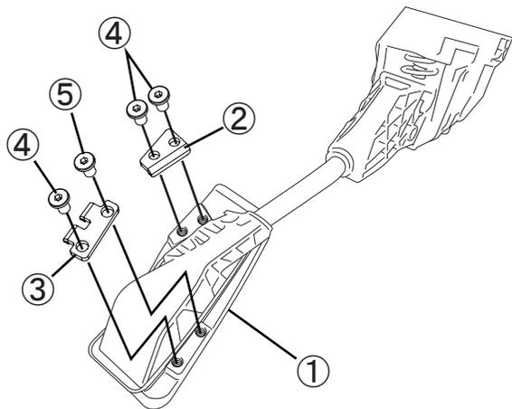
4. アクセルレータペダルに、アクセルペダルNEO ①をアッパーブラケット②、ローブラケット③、キャップボルト④、キャップボルト⑤を使用して取り付けます。
