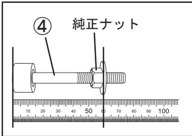
8. 純正ナットを取り付けたペダルストッパー④を車体に取り付け、カーペットを元に戻します。
