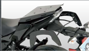
ヘブコ&ベッカー スポーツラック *2 タンデムシートをキャリアに換装。
