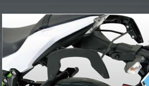
ヘブコ&ベッカー C-Bow サイドキャリア サイドバッグ装着でツーリング仕様へ
