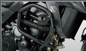
ヘブコ&ベッカー エンジンガード パッド付き *1 車両のデザインに合わせたパイプガード。
