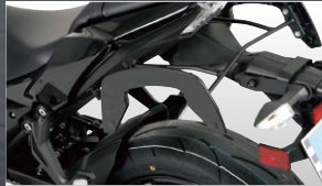
ヘブコ&ベッカー C-Bow サイドキャリア サイドバッグ装着でツーリング仕様へ
