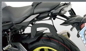
ヘブコ&ベッカー C-Bow サイドキャリア サイドケース装着でツーリング仕様へ
