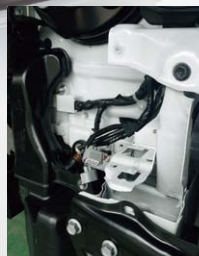
純正エアダクトの吸入口は、バルクヘッド側を向いているため効率よく空気を取り込めない。
