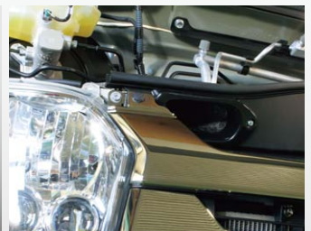
ラムエアインテークキットの吸入口は、フロントグリル内にあり走行風を効率よく取り込むことが可能となる。
